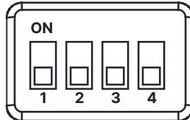
キーボード本体背面に設置されたDIPスイッチのON/OFFで、各スイッチに割り当てられた機能の有効/無効を切替可能です。工場出荷時は全てOFFです。（\*スイッチが下がった状態）
