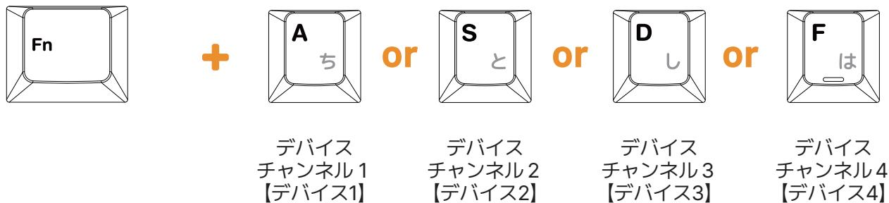
◎ペアリング後に各チャンネルに割り当てたデバイスへ接続を切り替える際にも同様に、FnキーとA、S、D、F いずれかのキーと一緒に1秒程度長押しで切り替えます。
