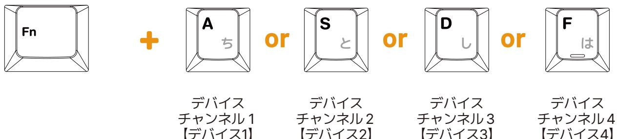
いずれかのチャンネルを選択すると、**A** \* 右横のLEDインジケータが青色で0.5秒間隔で2度点滅し、消灯します。
