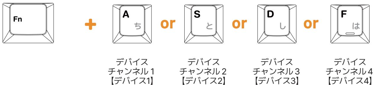
いずれかのチャンネルを選択すると、**A** \* 右横のLEDインジケータが青色で0.5秒間隔で2度点滅し、消灯します。
