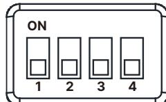
キーボード本体背面に設置されたDIPスイッチのON/OFFで、各スイッチに割り当てられた機能の有効/無効を切替可能です。工場出荷時は全てOFFです。（\*スイッチが下がった状態）
