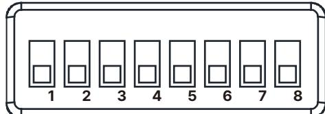
キーボード本体背面に設置されたDIPスイッチのON/OFFで、各スイッチに割り当てられた機能の有効/無効を切替可能です。工場出荷時は全てOFFです。（\*スイッチが下がった状態）
